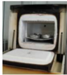
電気炉(白金皿使用) ② 600°Cにて乳歯を灰化。放冷後、乳歯灰化物の重量を測定。これを炭酸カルシウム重量としてカルシウム量を算出
