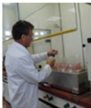
水浴(ドラフト内) ⑤ 乳歯灰化物の溶解液のろ液にイットリウム担体(45.1 mg)添加、イオン交換水にて液量を500 mLとし、水浴にて加温(40°C)、0.1%メチルオレンジ(pH3.0-4.4以下で赤色)滴下、シュウ酸6 gを添加
