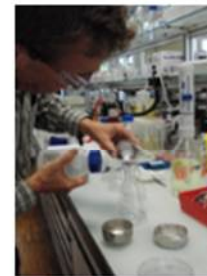
⑨ 白金皿上の分解物を20%塩酸15 mLで溶かして三角フラスコに入れ、イオン交換水にて水量を60-70 mLとする
