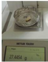
電子化学天秤 ① 白金皿上の乳歯の重量を測る
