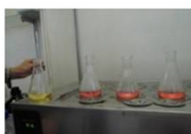
⑪ 0.1%メチルオレンジを滴下(赤色)、25%アンモニア水を黄色になるまで添加、その後更に1 mL添加(Srとの分離時刻を記録)水浴上にて液温40°Cで10分程加温
