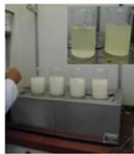
⑥ 10%酢酸アンモニウム165 mL、25%アンモニア水8 mLを加えてpH5~5.5以上とし、加温(液色はpH3.0-4.4以上で黄色)、シュウ酸塩析出
