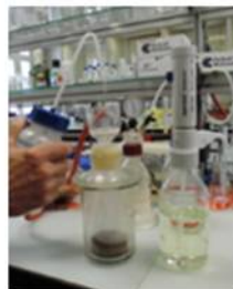
⑫ G4ガラスフィルターにて吸引ろ過(受器の三角フラスコに5%塩化ストロンチウム溶液5 mL添加)
