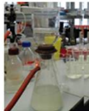
吸引ろ過 ⑦ シュウ酸塩を灰分の残らない濾紙にて、吸引ろ過。洗浄は0.1%シュウ酸アンモニウム
